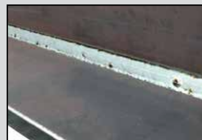
■ Acél sarokvarrat PB | 10,0 mm FOCUS.ARC
