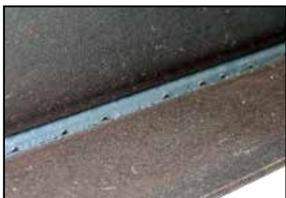
■ Acél sarokvarrat PB | 8,0 mm FOCUS.ARC
