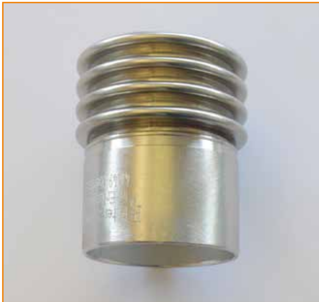
Körkörös hegesztés | kézi hegesztőpisztollyal (3,0 mm a 0,2 mm-en)
