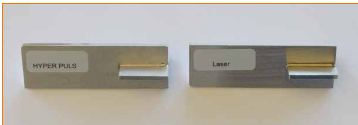
Gyógyszeripari sarokvarrat hozaganyag nélkül, kézi pisztollyal
