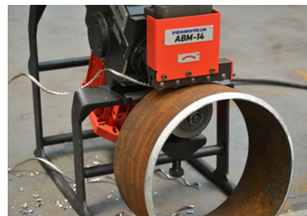
Ovális munkadarab és cső leélezése
