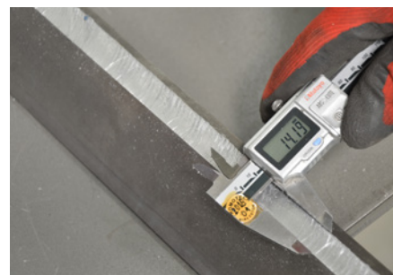
Leélezés 14 mm szélességig
