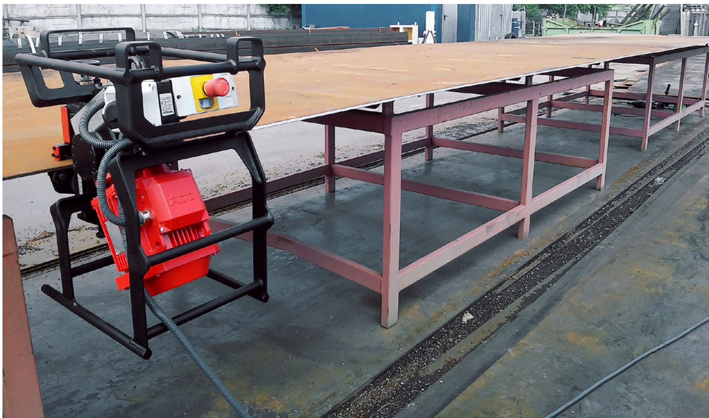
Az ABM-14 automatikusan halad a lemezen
